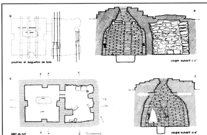
Abb. 15. Konstruktionsmerkmale der Königsgruft unter dem Saal I im Palais Oriental in Mari (aus Margueron 2004 Fig. 335)
